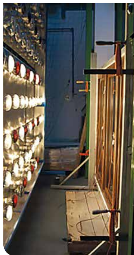
Badanie odporności okna na działanie zmiennej temperatur w zakresie +50°C do +75°C. Fot. Oknotest.pl
