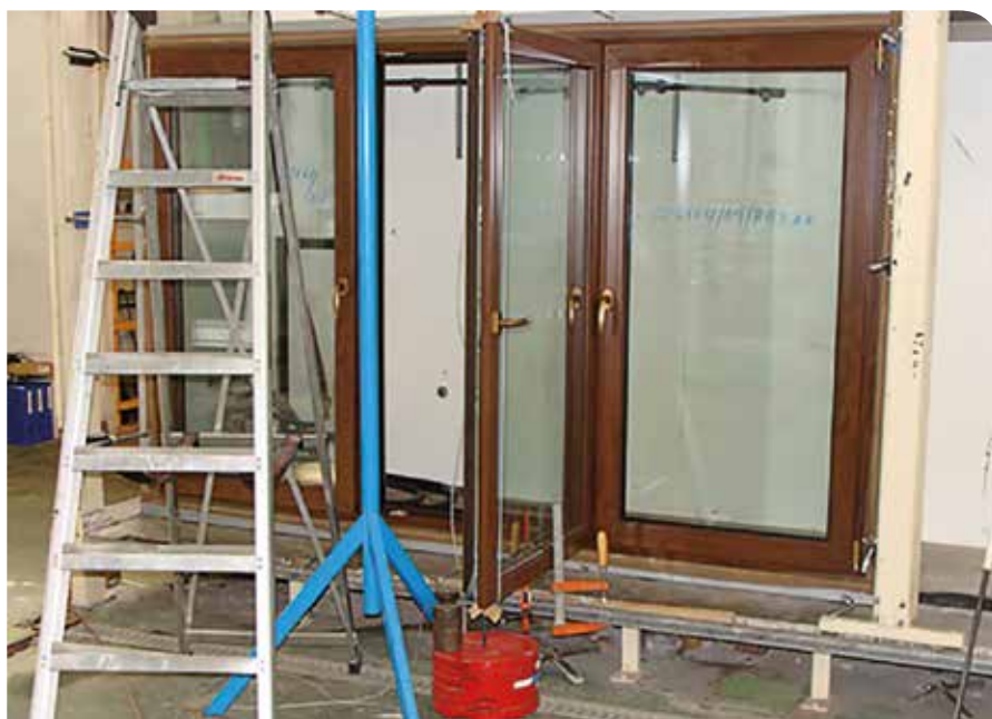
Badanie wytrzymałości mechanicznej. Obciążenie 800 N (=81,5 kg)
